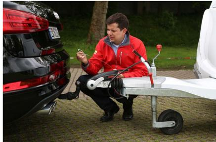
Für uns ist wichtig, für die einwandfreie Funktion dass das Abreisseil, wie gezeigt an der Deichsel durch die dafür vorgesehene Öse geführt ist und an keiner Stelle eingeklemmt ist.
