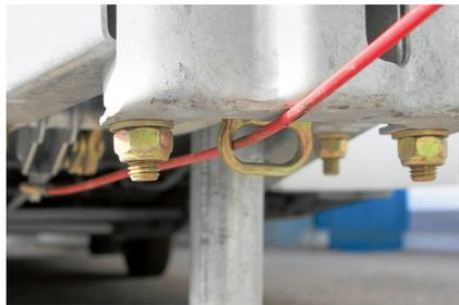
Das Abreisseil darf nicht mehr um den Kugelkopf der Anhängerkupplung geschlungen werden. (Abnehmbar sowie Feste Kugelköpfe) Beim abspringen des Anhängers könnte das Seil mit abspringen und der Anhänger würde nicht mehr abgebremst.
